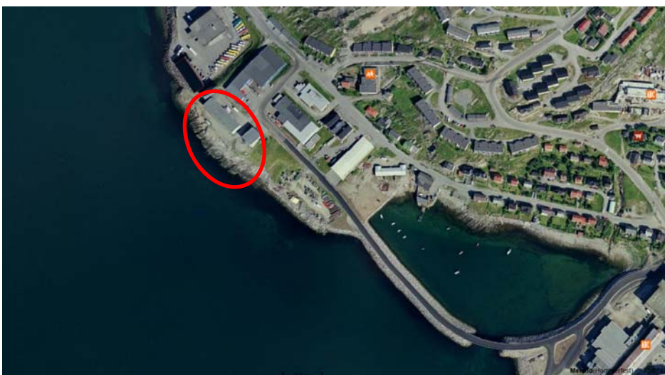
Figur 4: Ortofoto av området fra 2004 (kilde finn.no/kart). Rød ring viser blottlagt berg. Ved eksisterende fylling er løsmasseykkelsen fra 0 til 8 m. Mektigheten er størst midt i Rossmollbukta, det vil si i den sørlige del av eksisterende fylling.
